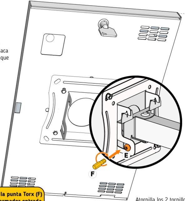
Debes usar la punta Torx (F) con un desarmador entrada hexagonal compatible
