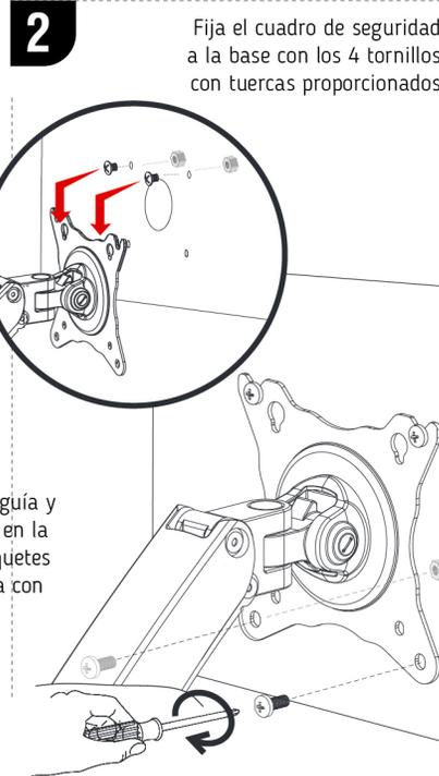
Fija el cuadro de seguridad a la base con los 4 tornillos con tuercas proporcionados
