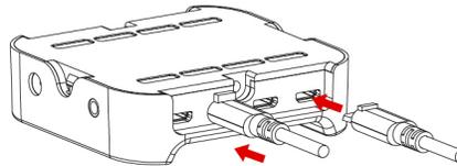
**4** Conecta el cable de alimentación a la alarma y al eliminador de pared
