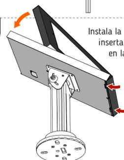
Instala la tapa del cuadro insertando las cejas metálicas en la parte inferior
