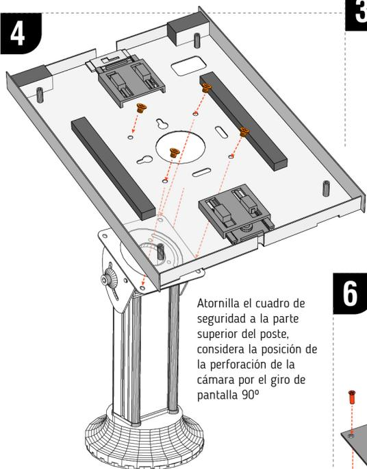
Atornilla el cuadro de seguridad a la parte superior del poste, considera la posición de la perforación de la cámara por el giro de pantalla 90°
