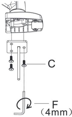
Realiza una perforación en la superficie para atravesar el tornillo, coloca la mariposa y aprieta
