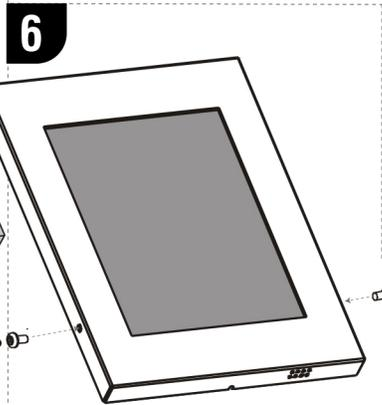
Atornilla firmemente los 2 tornillos de seguridad Torx con la llave incluida en el paquete
