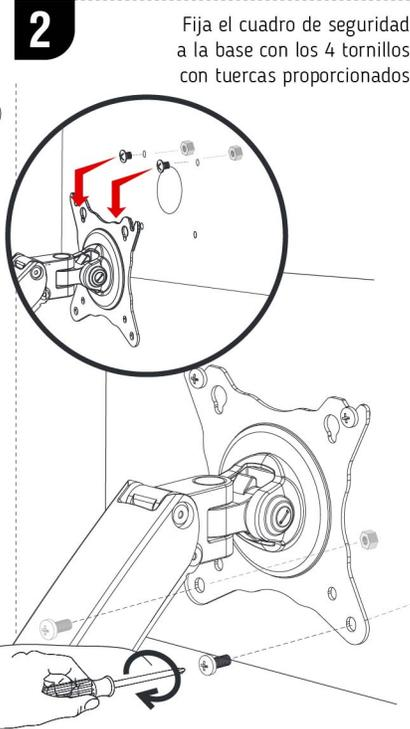
Fija el cuadro de seguridad a la base con los 4 tornillos con tuercas proporcionados
