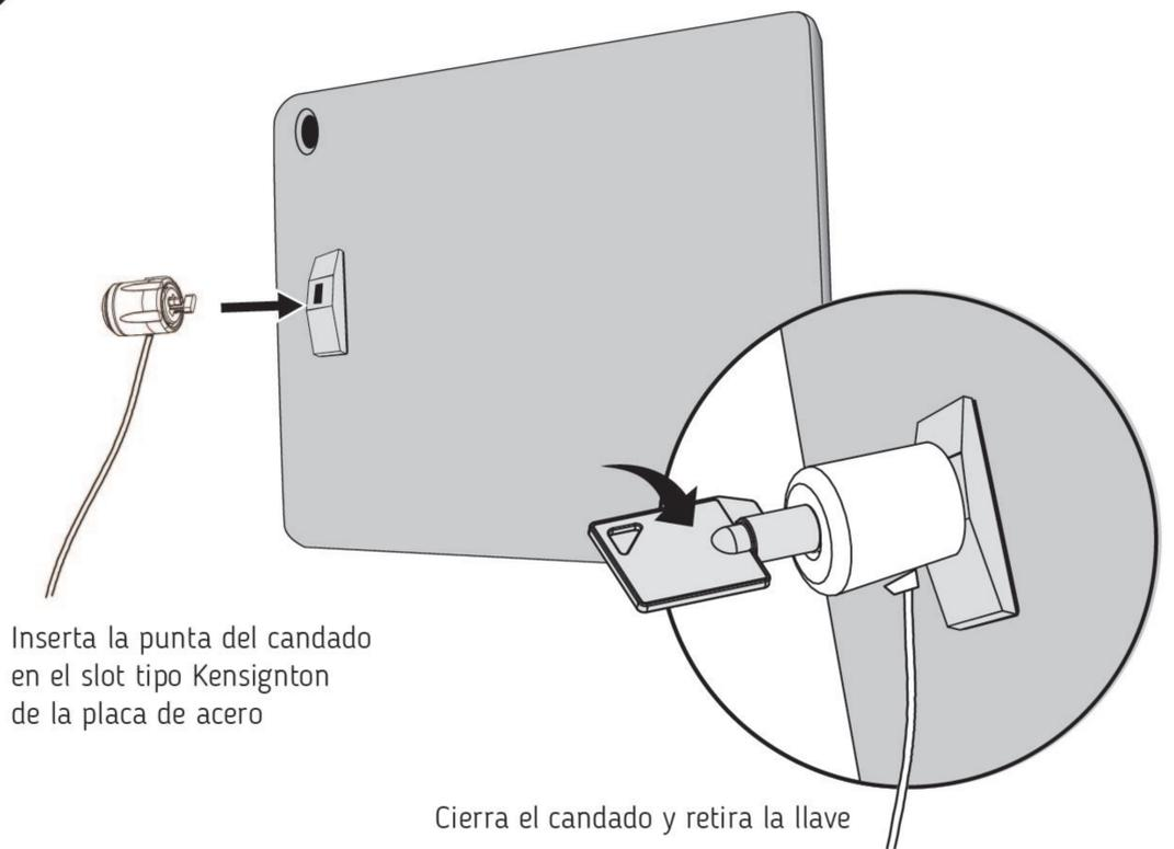
Inserta la punta del candado en el slot tipo Kensington de la placa de acero
